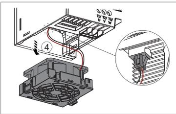
5. Free the fan clips and remove the fan from the fan cover.
